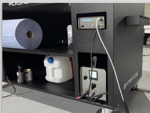
Opbergvakken voor reinigungsapparatuur, automatische elektrolyttoevoer en gereedschap
