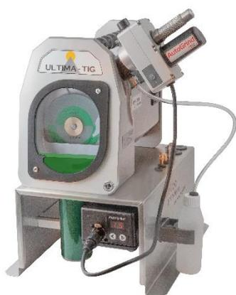
AutoGrind zum automatisierten Schleifen für ULTIMA-TIG kann nachgerüstet werden.
