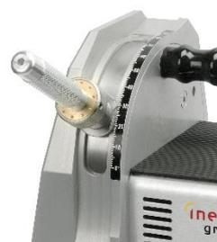
**Es ist nicht notwendig, die Elektrode fest an die Diamantscheibe zu drücken. Ein leichter Druck und die Rotation der Diamantscheibe sind ausreichend, um die Elektrode zu schleifen.**
